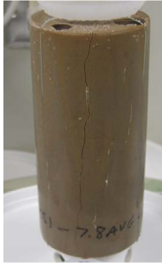
CS-T5HCS1-6 in DIW (note vertical crack)
