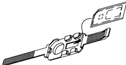
**Figure 5.37** EXT-RAD Extremity Dosimeter
